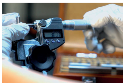
Calibración de instrumentos dimensionales (calibres, reglas, etc.) con patrones trazables.
